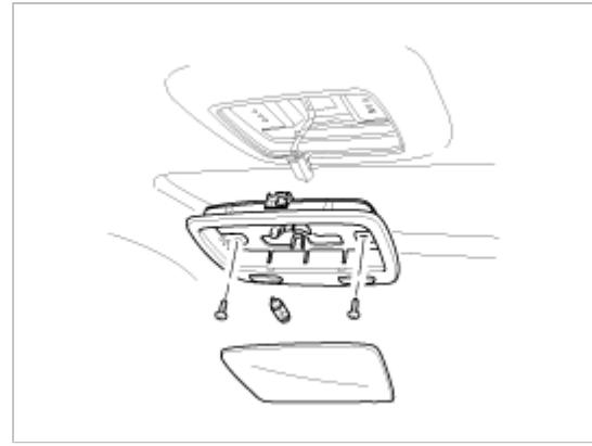
3. 拧下2个螺钉,分离3P连接器,拆卸室内灯总成。
